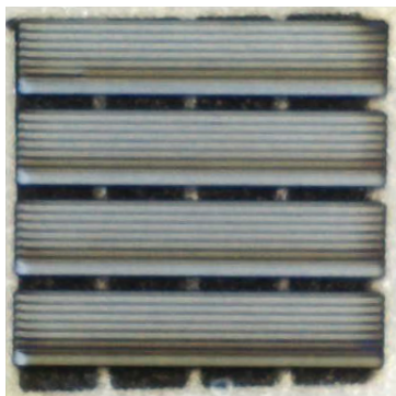
Figura 1.4: Realizzazione di strisce grafitiche su un prototipo 5 \times 5 \text{ mm}^2 e spessore 50 \text{ }\mu\text{m} .
