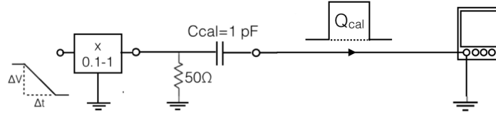
Figura 3.3: Circuito di iniezione di carica utilizzato nella procedura di calibrazione degli amplificatori.
