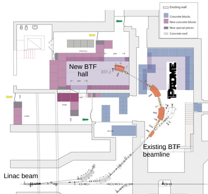
Figura 3.2: Collocazione dell'esperimento PADME nella sala sperimentale della BTF.
