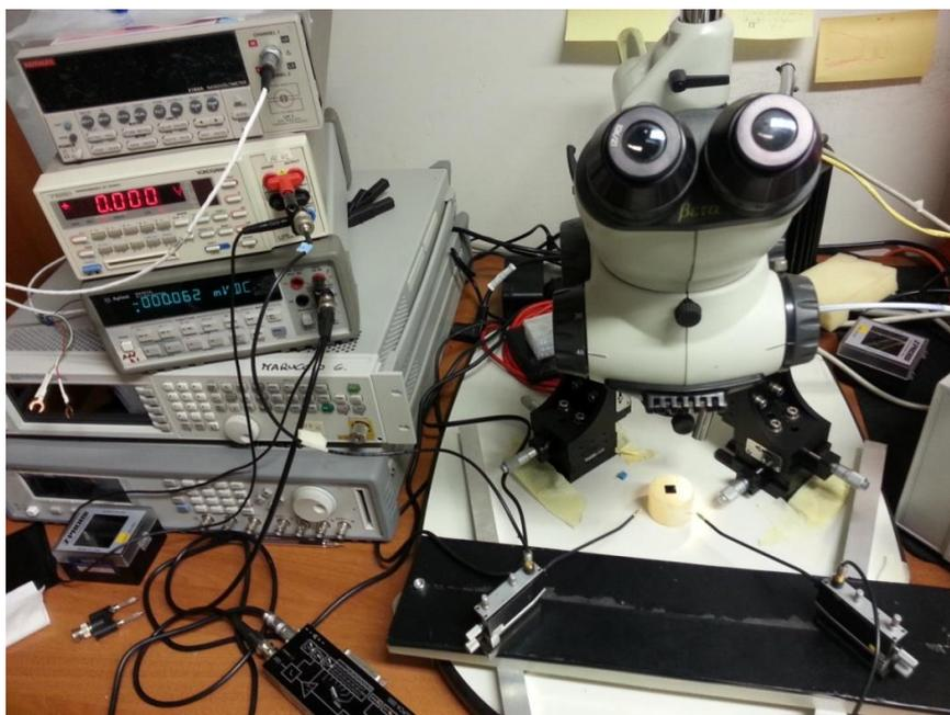
**Figura 3.16:** Set-up sperimentale per le misure elettriche (CNR NANO – NNL, Istituto di Nanoscienze, Lecce).
