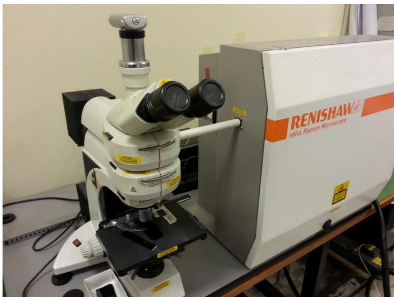
**Figura 3.8:** Renishaw InVia Raman Microscope (Centro Studi Nucleari “Enrico Fermi”, Politecnico di Milano).
