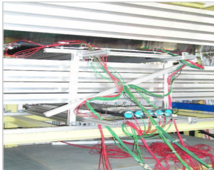
Figura 5.5: Sistema di scintillatori con cui si è realizzato il sistema di trigger ausiliario.
