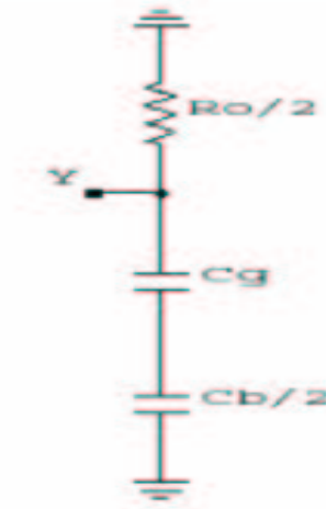
Figura 2.10: Circuito equivalente visto dalla strip di lettura durante la lettura della carica.
