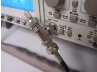
Figura 4.2: Adattamento di impedenza con terminatore a 50\Omega mediante l'ausilio di un connettore a T di tipo BNC.
