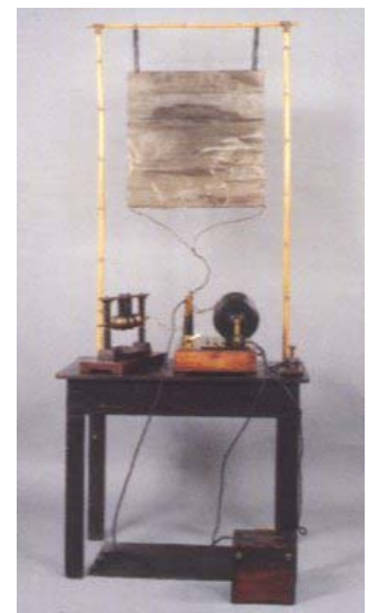
Riproduzione dell'apparato trasmittente dei primi esperimenti di Marconi. Si noti, in alto, l'antenna a pannello e in basso, a sinistra, l'oscillatore e, a destra, il rocchetto di Ruhmkorff (Fondazione Guglielmo Marconi, Collezione Bigazzi)
